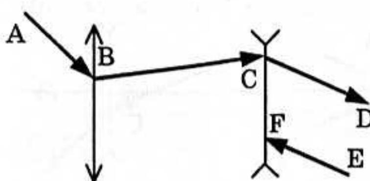
9. Собирающая линза  $L_1$  дает в точке  $A_1$  действительное изображение точечного источника  $A$ , расположенного на оптической оси линзы. Между источником  $A$  и линзой  $L_1$  поставлена еще одна собирающая линза  $L_2$ , положение фокусов которой заданы. Найти построением новое положение изображения источника. Рассмотреть случай, когда расстояние между  $A$  и  $L_2$  меньше фокусного расстояния линзы  $L_2$ .
