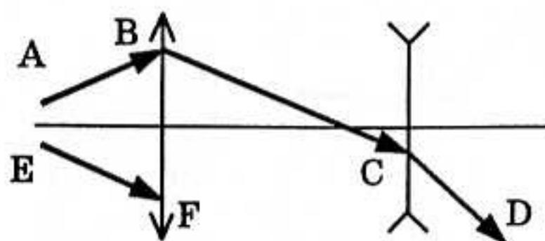
5. Где должны находиться фокусы двух линз, чтобы параллельные лучи, пройдя через линзы, оставались параллельными?
