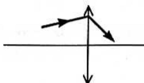
9. Определите построением положение фокусов линзы, если задана главная оптическая ось и ход произвольного луча.
