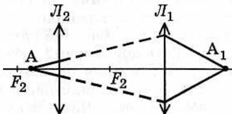
10. Линза разрезается плоскостью вдоль оптической оси на две равные части, которые раздвигаются на 1 см симметрично относительно оптической оси. Построить изображение светящейся точки  $A$ .
