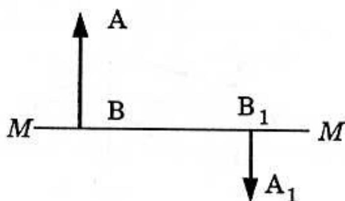
6. На рисунке показаны главная оптическая ось  $MM$  линзы, предмет  $AB$  и его изображение  $A_1B_1$ . Определите графически положение оптического центра и фокусов линзы.
