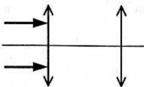
6. Собирающая линза  $L_1$  дает в точке  $A_1$  действительное изображение точечного источника  $A$ , расположенного на оптической оси линзы. Между линзой  $L_1$  и источником  $A_1$  поставлена рассеивающая линза  $L_2$ , положения фокусов которой заданы. Найти построением новое положение изображения источника. Рассмотреть случай, когда расстояние между  $A_1$  и  $L_2$  больше фокусного расстояния линзы  $L_2$ .
