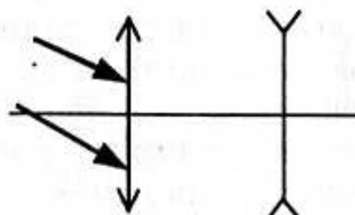
12. Линза разрезается плоскостью вдоль оптической оси на две равные части, которые раздвигаются на 1 см симметрично относительно оптической оси. Построить изображение светящейся точки  $A$ .
