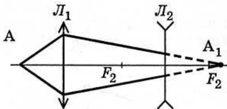
7. Где должны находиться фокусы двух линз, чтобы параллельные лучи, пройдя через линзы, оставались параллельными?
