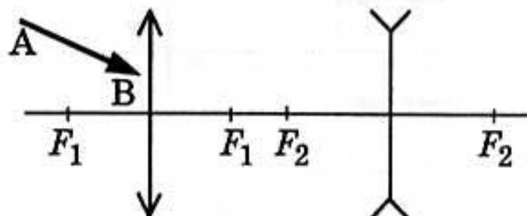
4. На рисунке показано расположение двух линз и ход луча  $AB$  после преломления в линзах. Построить дальнейший ход луча  $EF$ .
