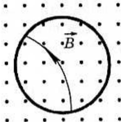
2. На рисунке пунктиром показан трек электрона в камере Вильсона, помещенной в магнитное поле. В каком направлении двигался электрон, если линии индукции поля направлены к нам?
