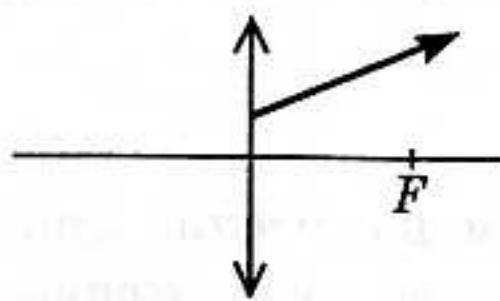
9. Найти построением положение светящейся точки, если известен ход двух лучей после их преломления в линзе. Один из этих лучей пересекается с главной оптической осью линзы в ее фокусе.
