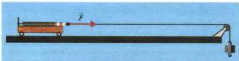
Рис. 8.1. Схема опыта по исследованию соотношения между действующей на тело силой и ускорением тела
