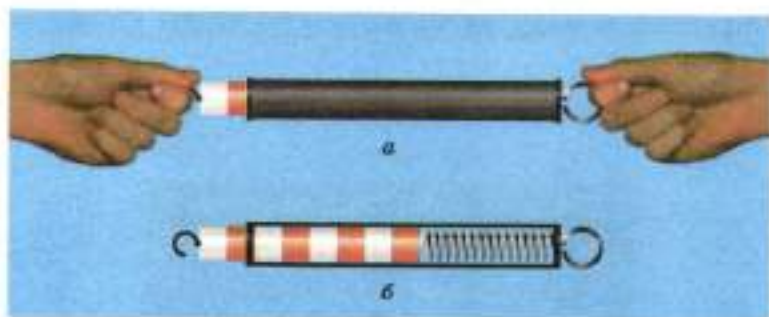
Рис. 7.4. Школьный пружинный динамометр: а — внешний вид; б — внутреннее устройство
