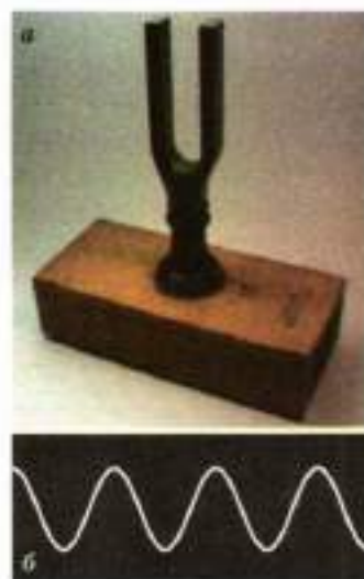
Рис. 17.3. Камертон (а) и запись звуковых колебаний (б)
