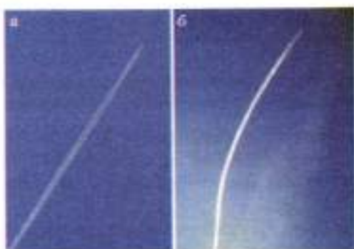
Рис. 1.6. Видимая траектория движения самолета относительно Земли: а — траектория самолета прямолинейная; б — траектория самолета криволинейная
