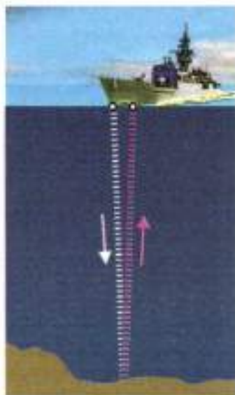
Рис. 17.5. Измерение глубины с помощью эхолота
