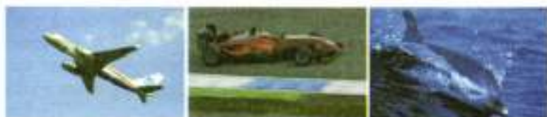
Рис. 11.4. Благодаря обтекаемой форме самолетов, автомобилей и дельфинов сила сопротивления при движении с большой скоростью значительно уменьшается
