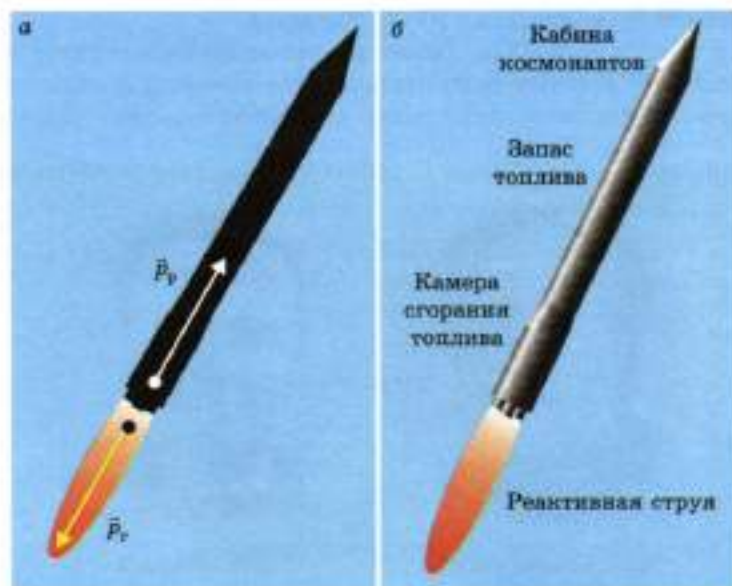
Рис. 12.3. Ракета: а — принцип действия; б — схема устройства.
